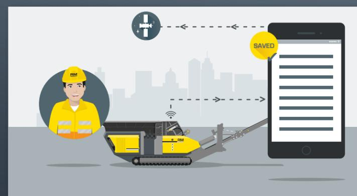
Non appena si ristabilisce una connessione alla rete mobile, i dati vengono sincronizzati con il server centrale.
