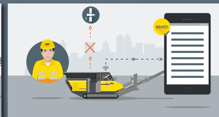
Se manca una connessione mobile attiva, tutti i dati registrati vengono memorizzati temporaneamente tramite WLAN sul dispositivo mobile.
